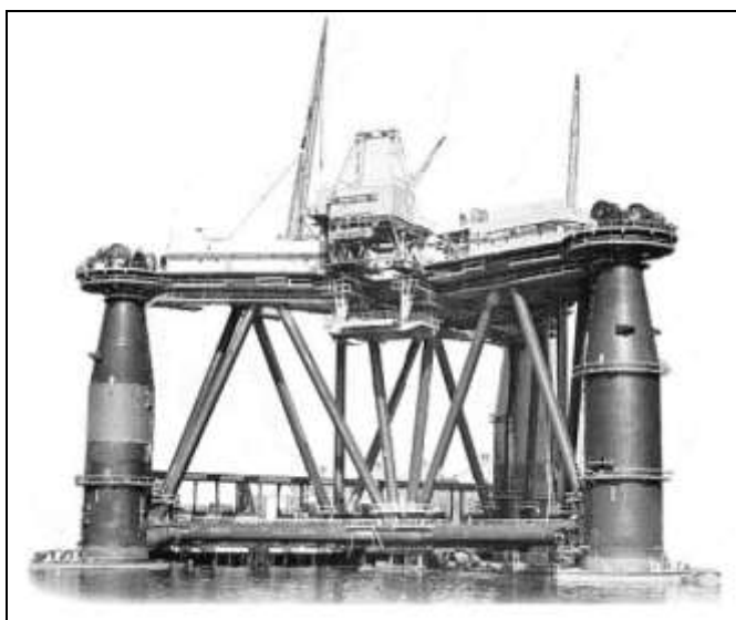
Спроектированная на базе погружной установки полупогружная ПБУ типа SEDCO 135 (наверху стабилизирующих колонн размещены лебедки системы якорного позиционирования, отсутствующие у погружной ПБУ)
