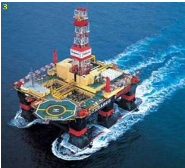
Полупогружная ПБУ в транспортном положении – осадка в рабочем положении нанесена на стабилизирующих колоннах
