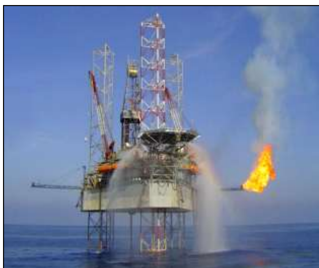
Самоподъемная ПБУ ATWOOD BEACON в рабочем положении (задействовано факельное устройство и система орошения жилого комплекса)
