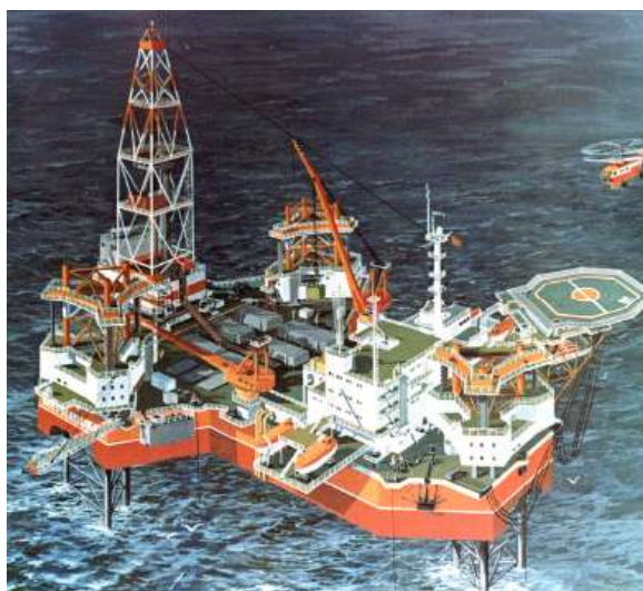
Самоподъемная плавучая буровая установка "Мурманская" проекта 15402 (СПБУ 6500/100)
