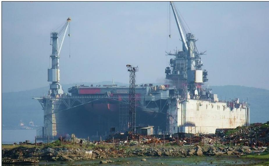
*Рисунок 10. Вид ПД-50 с судном внутри (подъемная сила 80000тн).*
