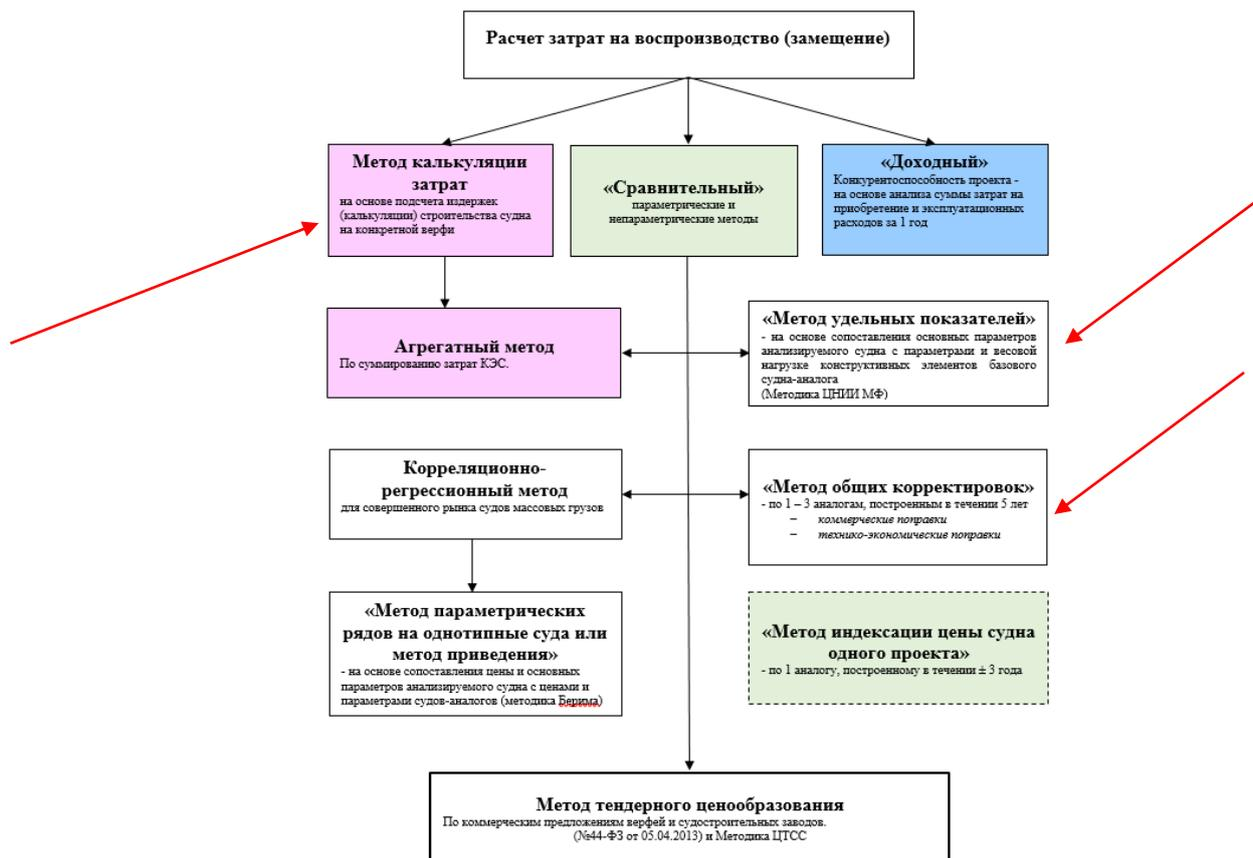
Рисунок 22 Существующие методы определения затрат на строительство судов
